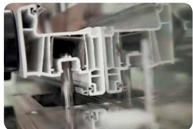
Фрезерный станок для сверления тройного отверстия и шуруповёрт для армирования
