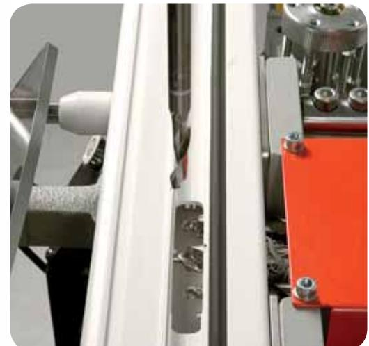
Станок для фрезеровки водоотливных каналов с тройным сверлением и копировально-фрезерных работ
