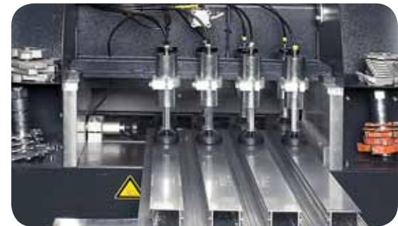
Многопрофильный станок для фрезеровки торцов импоста
